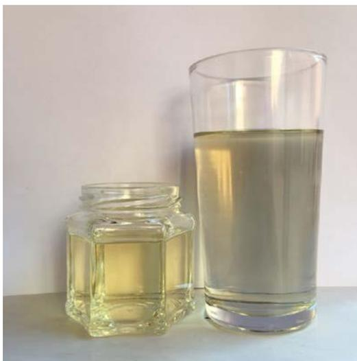
A cor não é uma propriedade crítica, porém é útil se associada a outros ensaios. À medida que o Óleo vai oxidando a sua cor vai escurecendo. A observação da aparência da amostra é importante já que se pode detectar presença de sedimentos, borra sujeira e
