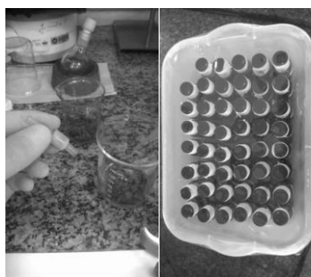
Figura 1: Processo de impregnação e acondicionamento dos cartuchos Sep-Pak ® C 18 com 2,4-dinitrofenilhidrazina.
